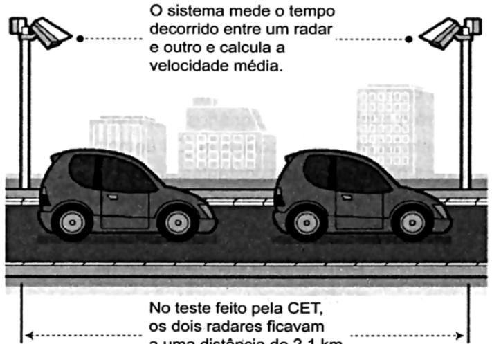
As medições de velocidade deixariam de ocorrer de maneira instantânea, ao se passar pelo radar, e seriam feitas a partir da velocidade média no trecho, considerando o tempo gasto no percurso entre um radar e outro. Sabe-se que a velocidade média é calculada como sendo a razão entre a distância percorrida e o tempo gasto para percorrê-la.
